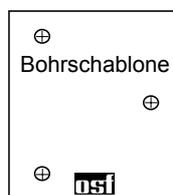
Für die Wandbefestigung verwenden Sie bitte die im Lieferumfang enthaltene Bohrschablone. Der Dampfgenerator darf nur auf einem geeigneten Untergrund mit ausreichender Tragfähigkeit und Temperaturbeständigkeit befestigt werden. Der Dampfgenerator SILVER-STEAM ist seiner Schutzart entsprechend vor Feuchtigkeit geschützt anzubringen.
