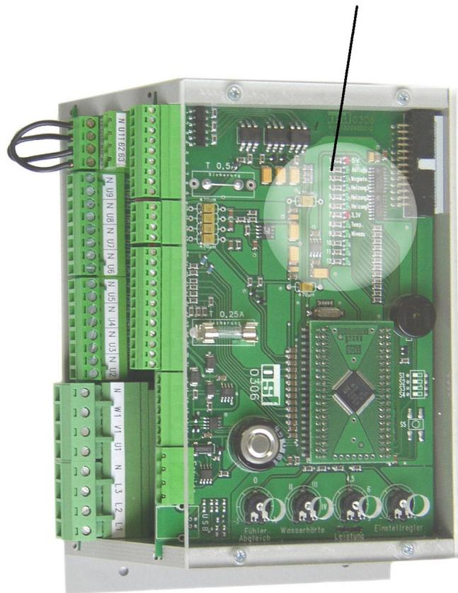
Die Steuerelektronik beinhaltet einige Kontroll-Leuchten, mit deren Hilfe die Funktionskontrolle bzw. Fehleranalyse vorgenommen werden kann.
