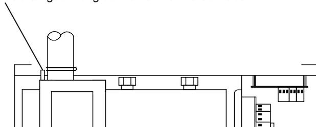
Im oberen Bereich des linken Edelstahlrohres (siehe Skizze) befindet sich eine Öffnung, die für die Belüftung des Systems unbedingt erforderlich ist. Diese Öffnung darf keinesfalls verschlossen werden. Ein Verschließen dieser Öffnung würde unweigerlich zu Funktionsstörungen der Anlage führen. Falls bei Betrieb der Anlage aus dieser Öffnung Wasser austritt, ist möglicherweise der Abfluss nicht ausreichend dimensioniert oder verstopft.
