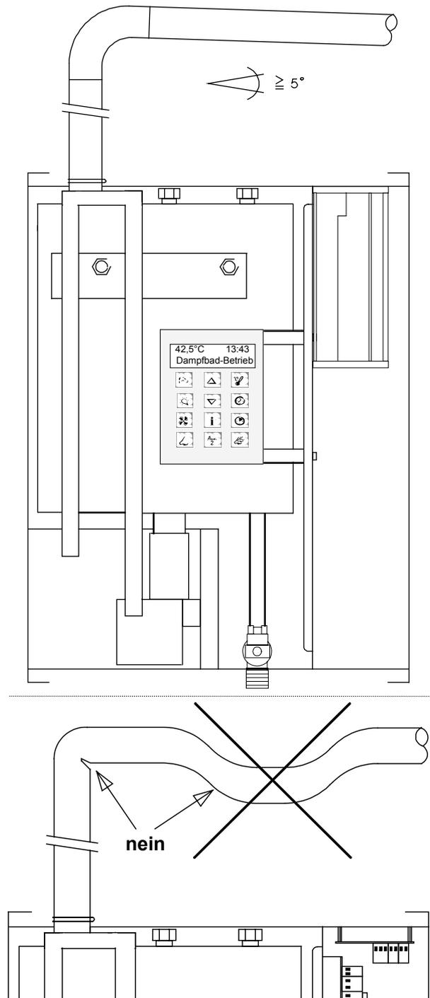
Die Dampfleitung ist auf ihrer gesamten Länge mit einer guten Wärmeisolierung zu versehen. Diese Isolierung verkürzt die Aufheizzeit der Dampfbadkabine, verringert die Kondensatbildung und leistet einen erheblich Beitrag zur Energieeinsparung.
