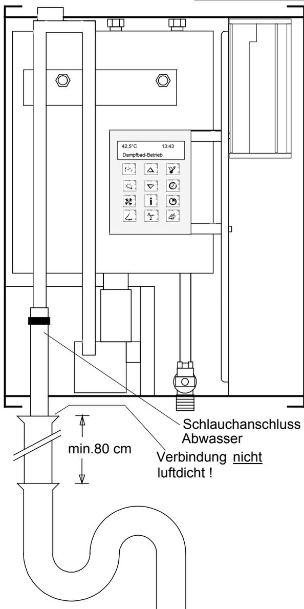
Der Anschluss für das Abwasser erfolgt mittels des mitgelieferten Schlauches an dem linken Rohrende (siehe Skizze). Die Verbindungsstelle wird mit einer Schlauchschelle fixiert. Mit diesem Schlauch wird die Verbindung zu dem bauseitig fest verlegten Abfluss hergestellt.
