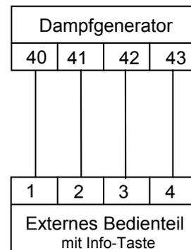
Diese **Verbindungsleitung darf eine Länge von max. 30 Meter aufweisen**. Eine Verlegung dieser Leitung in der Nähe von Netzleitungen ist zu vermeiden, um mögliche Störeinflüsse auszuschließen. Das externe Bedienfeld darf nicht innerhalb einer Dampfbadkabine installiert werden.
